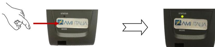
La confirmación de que la impresora ha sido encendida será confirmada por el parpadeo asíncrono de los tres LEDs y por el encendido del primer LED con una luz verde fija.
